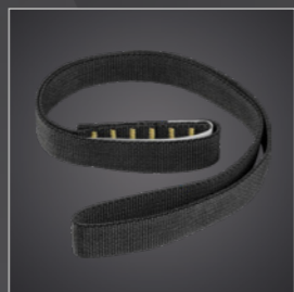
Loop FR dark grey 60 cm and 100 cm usable length available (fulfils EN 795 Type B, EN 566 and EN 354)
